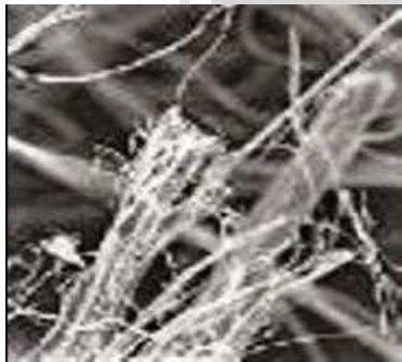
Fibras de amianto
