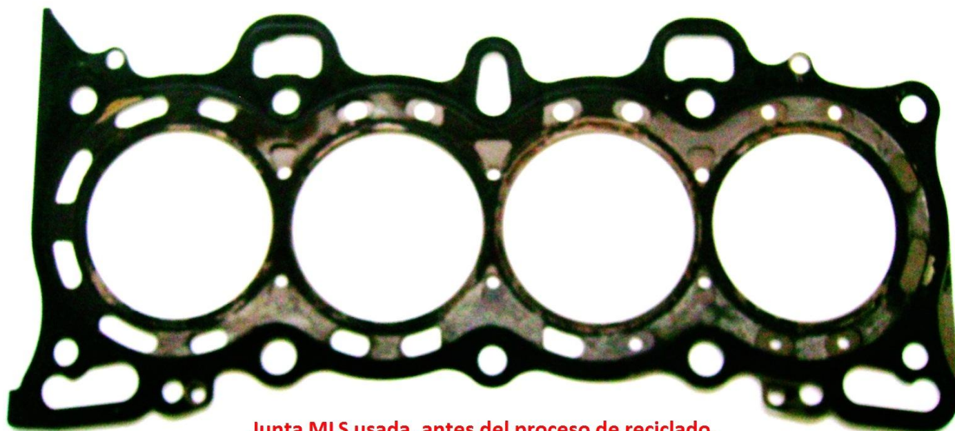
Junta MLS usada, antes del proceso de reciclado.
