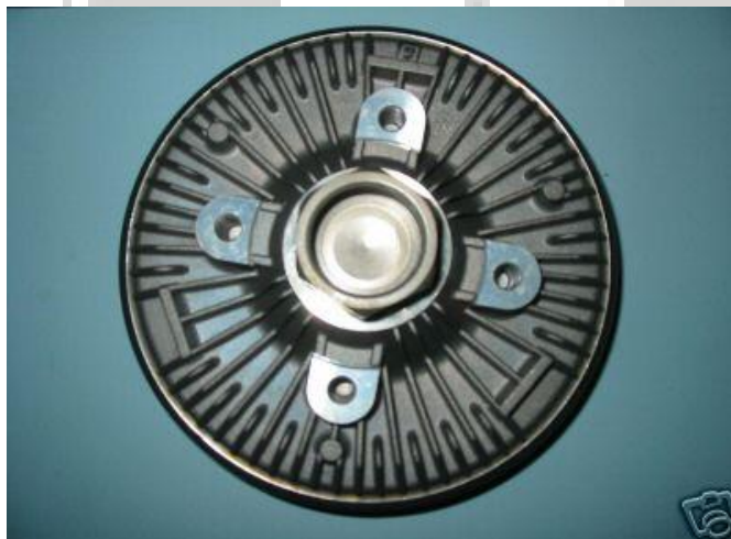
Acople viscoso de las paletas del ventilador.
